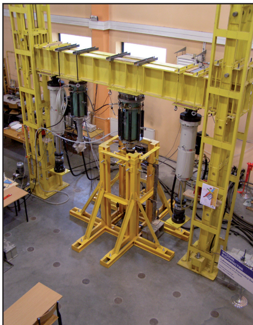
Rys. 7. Widok stanowiska do badania słupów zespolonych
